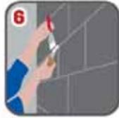
6) Aplique motas de RESISTOL™ NO MÁS CLAVOS® con un diámetro de 5 cm y un espesor de 2 cm sobre las marcas previamente hechas.
