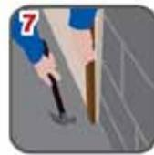
7) Coloque el tablero de yeso marca TABLAROCA®, presione con un mazo para distribuir el adhesivo correctamente.
