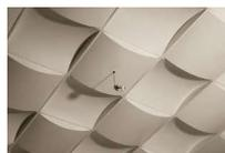
Plafones curvos termo formados de **LEXAN®** que pueden ser colocadas sobre una retícula en diferentes direcciones para obtener distintas y modernas apariencias en un espacio. Las placas pueden ser fabricarse cóncavas o convexas. Modulación de 61cm x 61cm con suspensión modelo **CENTRICITEE®**, **FINELINE®**
