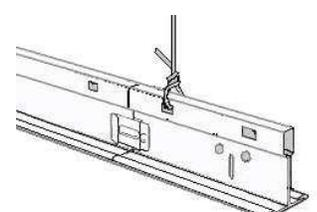
Se colocan las Tees conectoras insertando los clips de sus extremos en las ranuras correspondientes.
