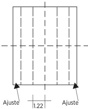
**Generar despieces:** Con el trazo también se determina el punto de arranque del sistema reticular, los ajustes y la ubicación de los colgantes que sostendrán el sistema. Es importante revisar que en los ajustes perimetrales no existan piezas menores a  $\frac{1}{3}$  del ancho del plafón.
