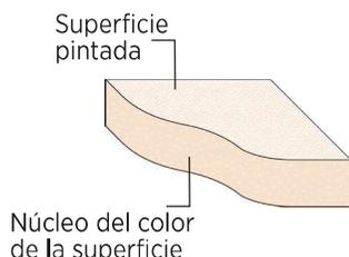
Plafones fabricados con un alto porcentaje de lana mineral, adicionado con los aditivos necesarios para obtener características acústicas y de resistencia contra fuego, además presentan un aspecto natural. Cada pieza es diferente debido a la alineación de las fibras, el color es integral (mismo color del núcleo y superficie), y el desempeño en absorción acústica es el ideal para obtener espacios confortables reduciendo la reverberación:
