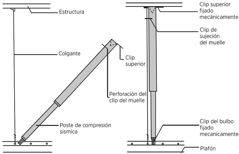
**B) Luminarias.-** Cualquier tipo de luminaria deberá ser sujeta y colganteada independientemente a la de la suspensión marca **USG DONN®**.
