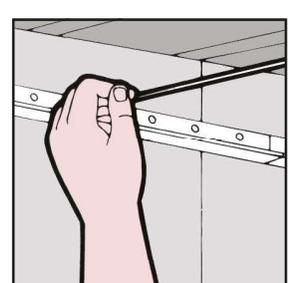
Se coloca otro hilo sobre el eje en el que se instalará la primera hilera de tees conectoras, para identificar y cuidar la alineación de las ranuras de las tees principales en las que se insertarán los clips de las conectoras. Hay que cuidar que este segundo hilo quede formando un ángulo recto (90°) con el método 3-4-5.
