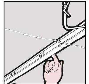
En cada hilera de Tees principales, hay que recortar los ajustes que sean necesarios para alinear las ranuras de las piezas con el hilo indicado, y así asegurar la correcta alineación de las conectoras.
