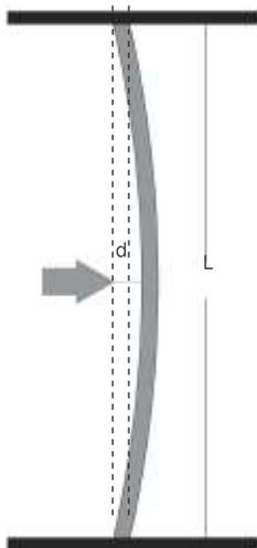
La deflexión que presenta un sistema se refiere específicamente a su capacidad de flexionarse al recibir un empuje lateral uniformemente repartido. La manera de medir esta propiedad es dividiendo la altura libre del muro en centímetros entre tres factores, el resultado es la medida en milímetros que se flechará en el sistema al recibir un empuje de 24 kg, por metro cuadrado, que es lo considerado para sistemas interiores de uso doméstico.
