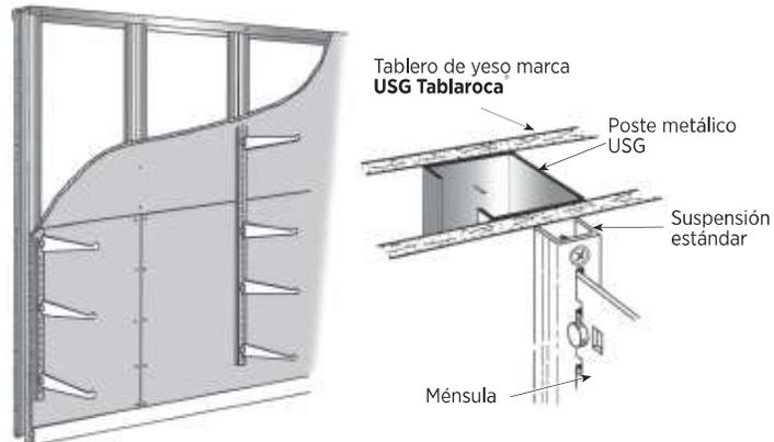
El bastidor del muro, ya sea calibre 20 o 26, deberá presentar todos los postes sujetos a los canales de amarre superior e inferior, con un tornillo tipo Framer (calibre 26) o TEK Plano (calibre 20).
