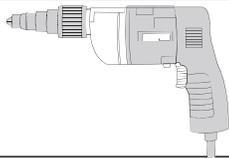
**Atornillador eléctrico** de 2,500 RPM para la instalación de la tornillería. Cuenta con un tope que evita la penetración excesiva de los tornillos en el tablero, entre otras ventajas.
