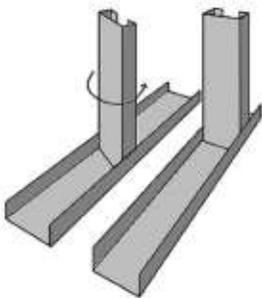
2. Ajuste la medida de los postes cortándolos 1 cm. más cortos que la altura total del muro. Si es necesario los postes pueden empalmarse insertando otro con un traslape mínimo de 20 cm. asegurándolos con dos tornillos en cada patín.
