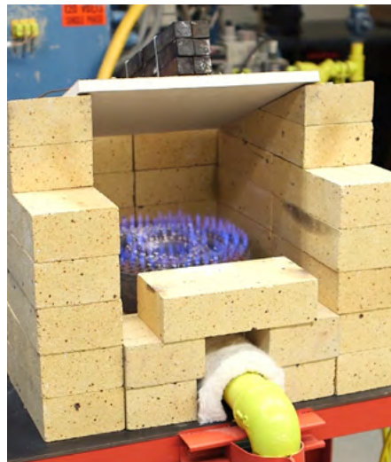
Figure 2: Échantillon de 13 po sur 13 po d'un panneau de gypse CGC Sheetrock MD Firecode X garni d'un poids de 16 lb et 13 oz en son centre afin de dramatiser le point de rupture.
