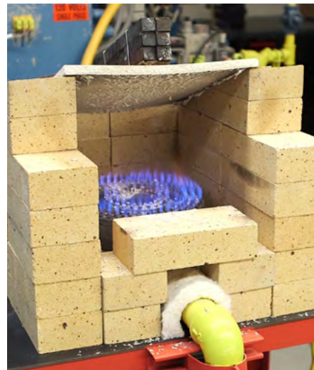
Figure 5: Après deux heures et deux minutes, le panneau de gypse CGC Sheetrock MD Firecode C ne présente aucun signe de rupture et on met donc fin à l'essai. Le panneau de Type C a résisté deux fois plus longtemps que celui de Type X.
