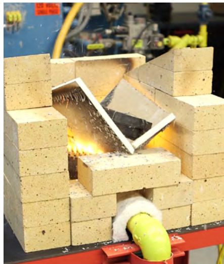
Figure 4: Après 57 minutes, le panneau de gypse CGC Sheetrock MD Firecode X se rompt en raison de l'effet thermique et de la charge qui y avait été superposée.
