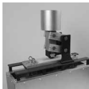
Soumis à un essai de résistance à l'abrasion de 1000 cycles à l'aide d'une brosse d'acier lestée de 11 kg (25 lb), le fini de plâtre mince de marque IMPERIAL ne montrait pratiquement aucune trace de pénétration, ce qui démontre son exceptionnelle résistance à l'abrasion.
