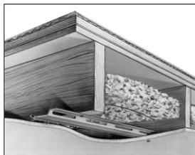
Ossature de bois – fixation flexible et coussin insonorisant/ignifuge THERMAFIBER.
