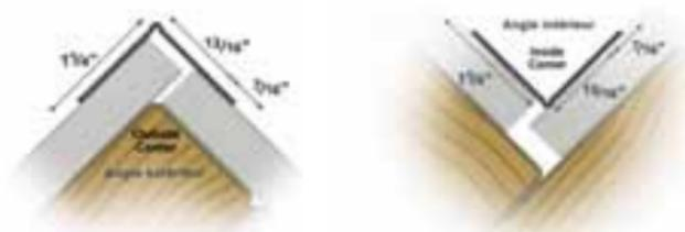
CONÇU POUR LES ANGLES INTÉRIEURS ET EXTÉRIEURS, LES VOÛTES, LES CAISSONS ET LES ANGLES DIVERS
