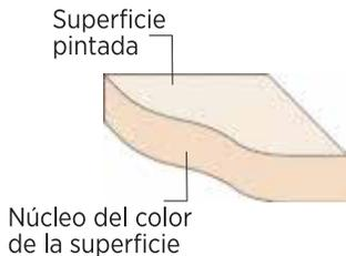
Plafones fabricados con un alto porcentaje de lana mineral, adicionado con los aditivos necesarios para obtener características acústicas y de resistencia contra fuego, con un acabado natural. Cada pieza es diferente debido a la alineación de las fibras, el color es integral (mismo color del núcleo y superficie), y el desempeño en absorción acústica es el ideal para obtener espacios confortables reduciendo la reverberación:
