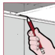
Después de cortar el tablero al tamaño adecuado, hágalo descansar en la retícula con el borde cortado contra la pared. Trace una línea en el dorso o cara del panel donde cruce el patín del ángulo. Haga un corte en la cara del tablero sobre la línea que corresponda a la profundidad de la depresión de la línea de sombra. Después, corte la orilla del tablero para recortar a la profundidad adecuada.
