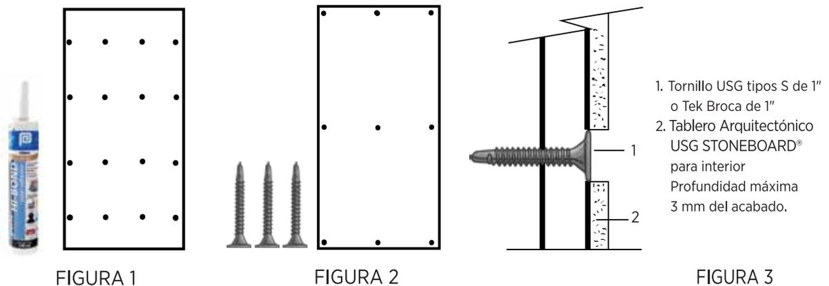
**Figura 1:** Se detalla la ubicación del adhesivo Pens® HI-BOND de Pennsylvania.
