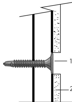
1. Tornillo USG Tipo S de 1" para Cal. 26 o USG Tek Broca de 1" para Cal. 20
