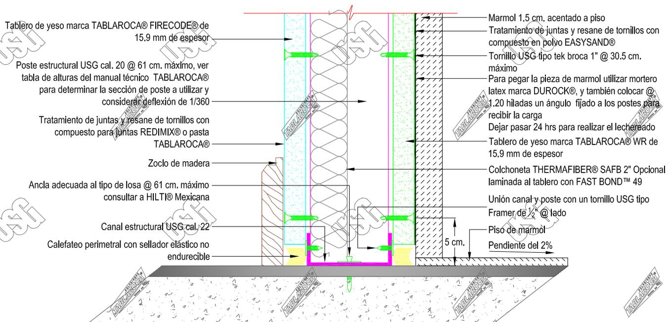
**Nota:** Los postes y canales se unen entre si con un tornillo USG Framer de ½" en arranque, terminación de muro, esquinas, puertas, ventanas y cuando el muro lleve acabado cerámico
