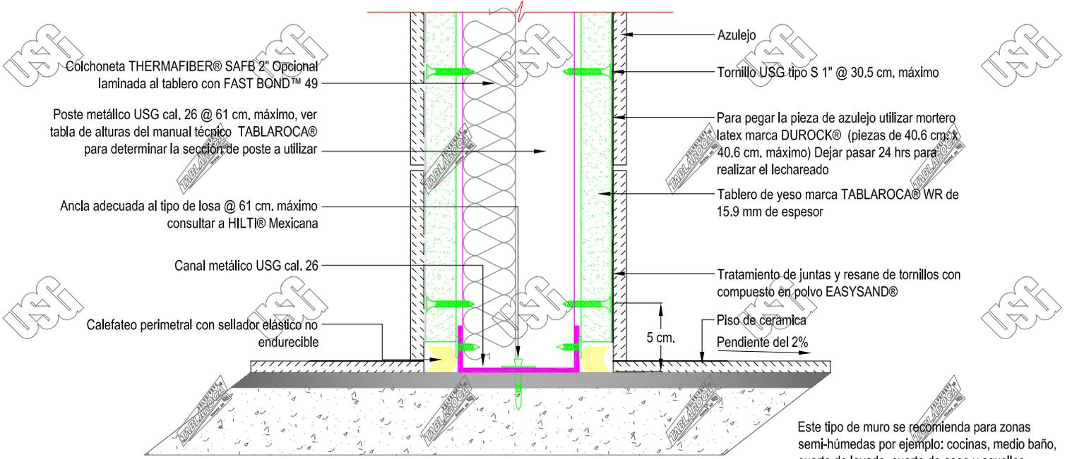
**Nota:** Los postes y canales se unen entre si con un tornillo USG Frammer de 1/2" en arranque, terminación de muro, esquinas, puertas, ventanas y cuando el muro lleve acabado cerámico
