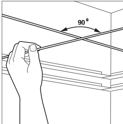
**Step 7: Install hanger wires.**
